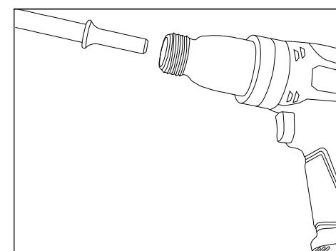
3. Entornille el retén del resorte en el cilindro girando el gancho superior en sentido horario. Asegúrese de que el retén del resorte esté bien fijado.
