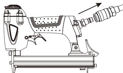
2. Tournez l'outil de façon à ce que l'entrée d'air soit orientée vers le haut. Appliquez 2 ou 3 gouttes d'huile pour outil de fixation pneumatique dans l'entrée d'air. N'utilisez pas d'huile détersive, d'additif pour essence ou d'huile à outil pneumatique. N'ajoutez pas d'huile détergente ni d'autres additifs : ces lubrifiants accéléreraient l'usure des joints et des butoirs de l'outil, ce qui nuirait à son rendement et augmenterait la fréquence des entretiens.
