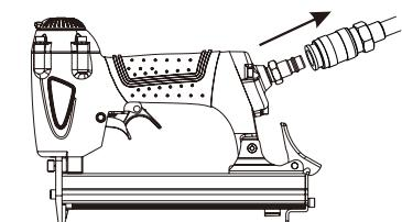
2. Gire la herramienta de forma tal que la entrada de aire d e hacia arriba. Coloque 2 a 3 gotas de aceite neum tico de la herramienta de la cerradura en la entrada de aire. No utilices aceite detergente ni aditivos puesto que estos Lubricantes causar n el desgaste acelerado de los sellos y amortiguadores de la herramienta, lo que resultar  en el mal funcionamiento de la misma y elevar  la frecuencia del mantenimiento.
